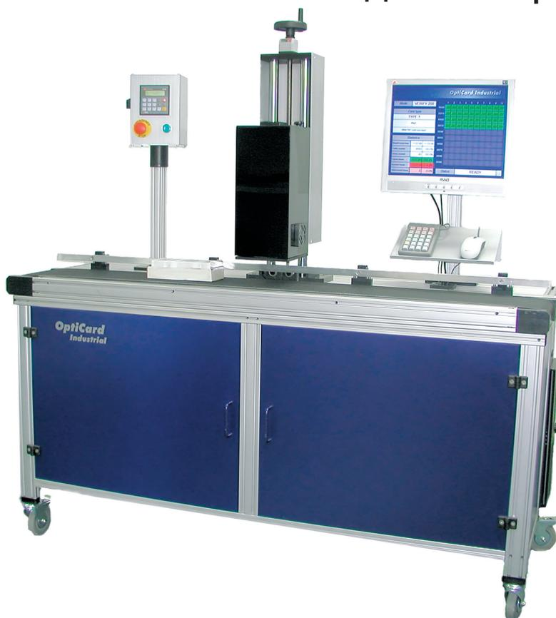
OptiCard IND 500 E — современное конвейерное устройство для подсчета конвертов и различных видов пластиковых карт. Устройство считает на основе цифрового электро-оптического формирования образа и его распознавания. Такой алгоритм работы позволяет OptiCard IND 500 E точно считать конверты и все известные виды карт, в том числе - прозрачные карты, бумажные карты, карты с цветным ребром и карты в прозрачной упаковке.
